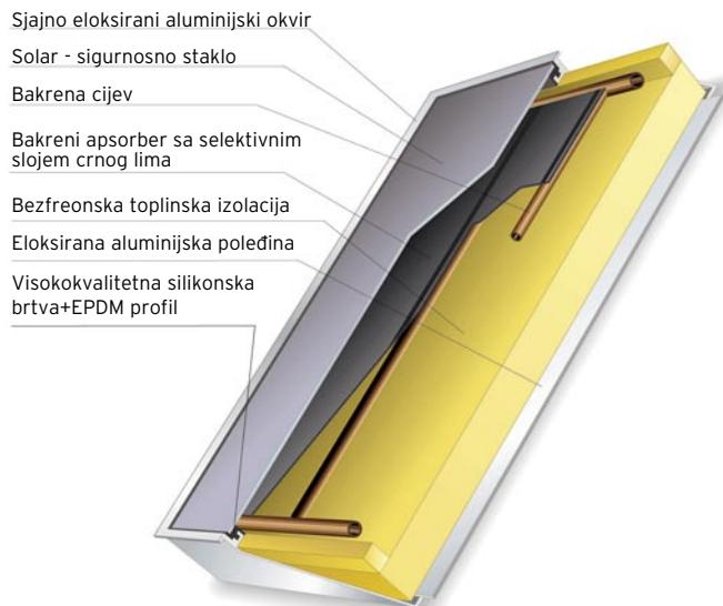
Presjek Vaillantovog VFK pločastog kolektora
