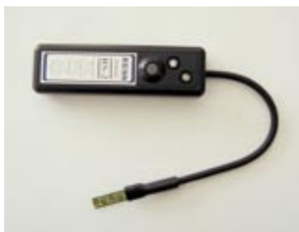
Elektronički uređaj kojim dimnjačar ispituje koncentraciju ugljičnog monoksida i vodene pare na izlazu iz plinskog ložišta.
