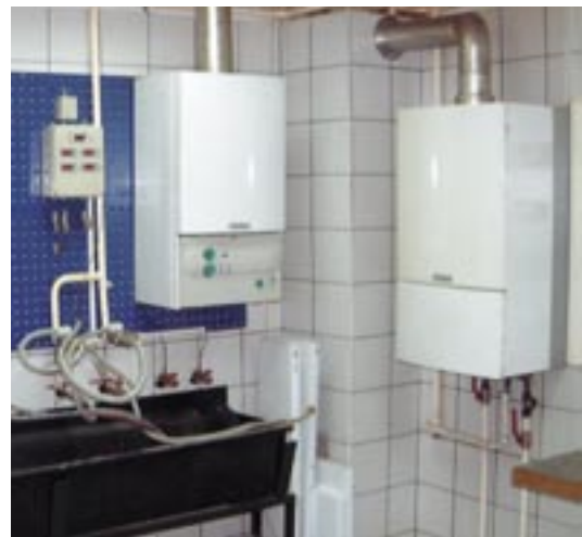
Ispitna stanica sa četiri mjesta i potrebnim priključcima i instrumentarijem.
