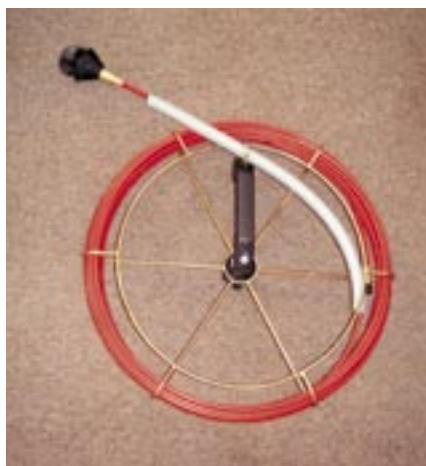
Dimnjačarska četka više nije od čelične saje, nego od otporne plastike duge 15 metara.
