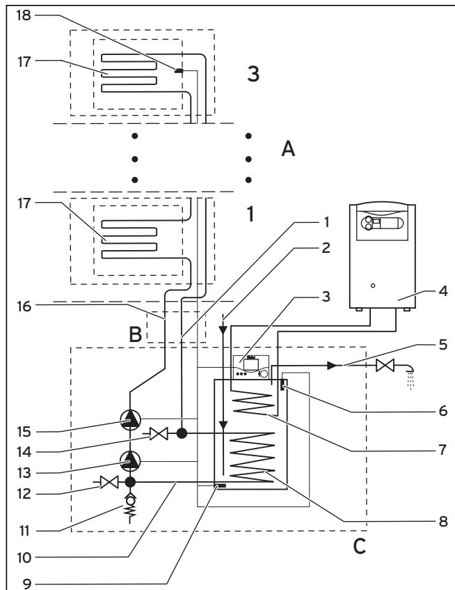
Sl. 2.3 Glavne komponente sustava auroSTEP plus sa spremnikom VIH SN 250/3 iP (načelni crtež bez pribora za priključivanje)
