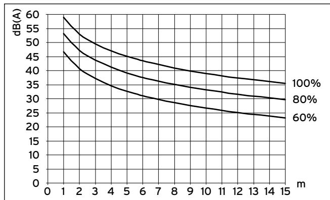
Sl. 6.5 Razina zvučnog tlaka dvije vanjske jedinice u dB(A),
