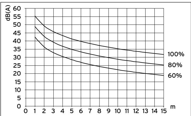
Sl. 6.4 Razina zvučnog tlaka dvije vanjske jedinice u dB(A),
