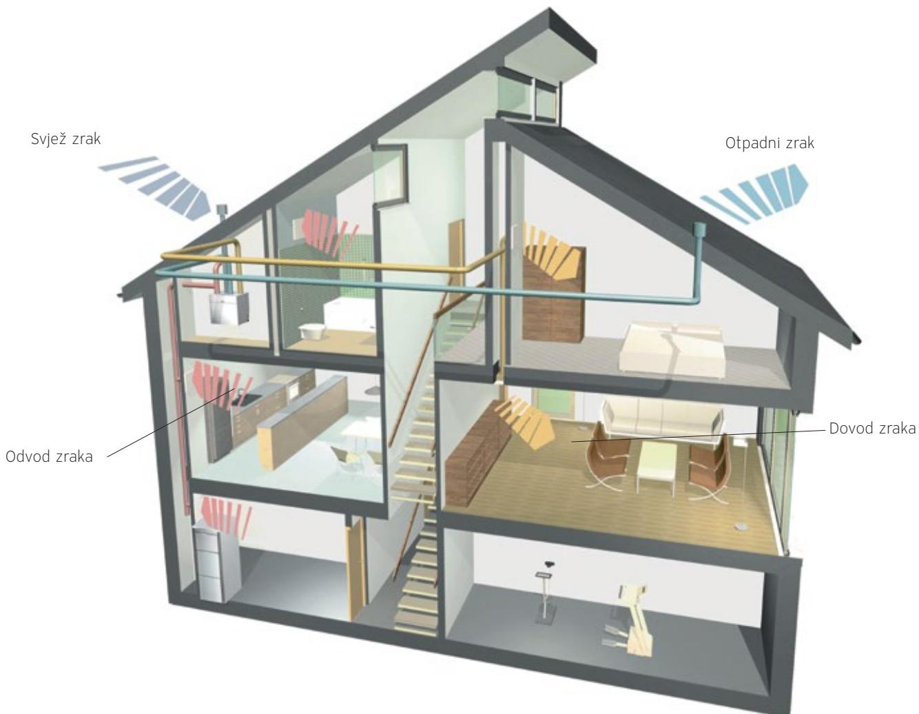
Zrak iz kuhinje, kupaonice i WC-a odvodi se van, dok se njegova toplina putem izmjenjivača topline prenosi na svjež ulazni zrak koji ulazi u sobe.
